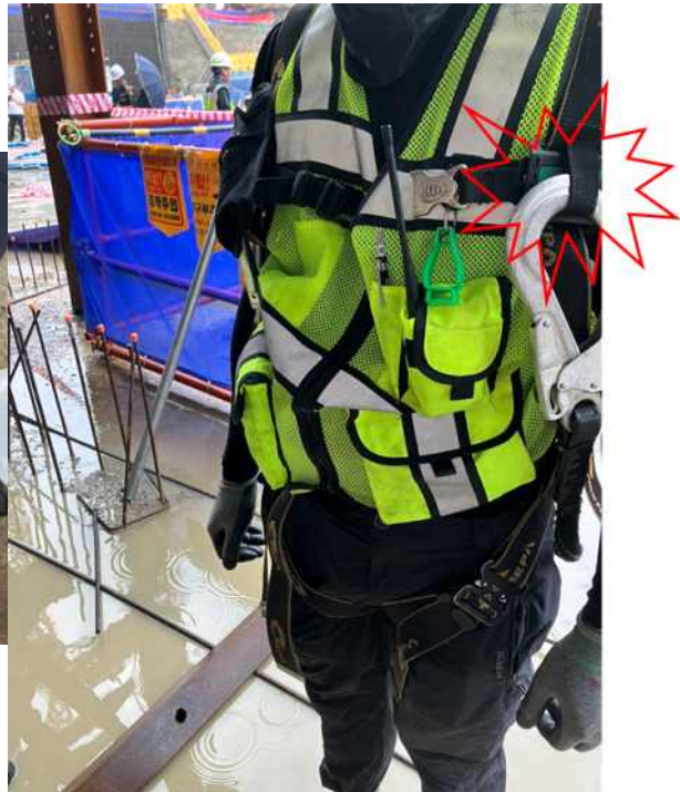
[사진4] 재해자가 착용했던 안전벨트 (동일모델 착용 모습과 파단된 부위)
