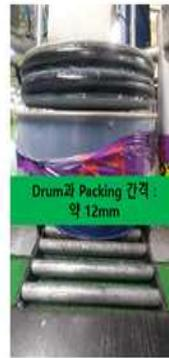
1. Drum과 Pump Packing 간격이 좁아, 실리온 소진 완료 후 Drum 분리가 어려움 - 균질하게 무덤 공정
