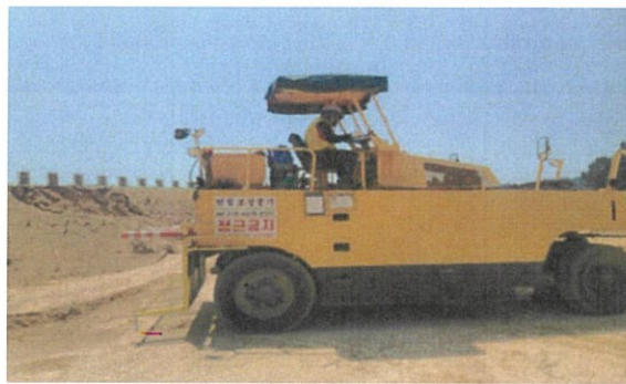
타이어롤러 후방 협착방지 장치 및 감지기 설치(2공구)
