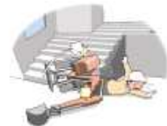
작업 중 굴착기가 넘어지면서 운전석에서 이탈한 운전자 깔림
