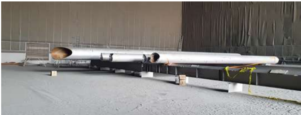
쇼트 작업을 마치고 거치대 위에 쌓인 강관 파이프. 이 파이프를 지게차에 실어 도장 작업장으로 옮겨야 한다
