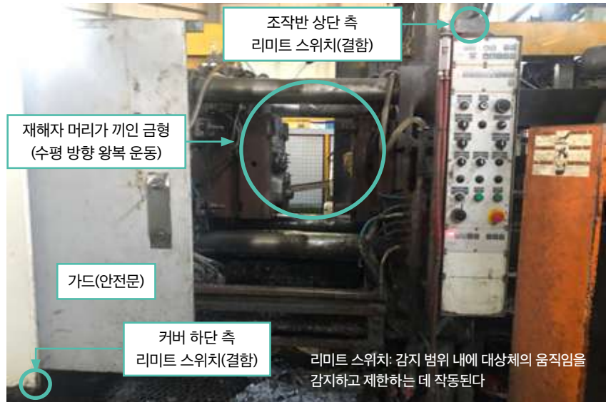
다이캐스팅 머신 가드 내부 모습 및 방호장치 위치(기계 상단과 하단의 리미트 스위치)
