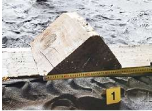
지게차 포크에 구름방지 고임목이 3개가 설치된 상태에서 파이프가 없으면 작업자가 잔여 고임목 1개를 설치하는 방식이었다
