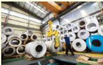
천장 크레인(호이스트) 인양
