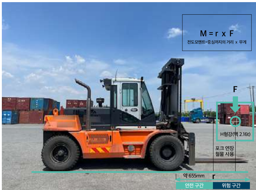
2.45t 지게차에 연장 슬리브가 장착된 모습과 H형강이 적재된 위치
