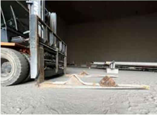
지게차 포크에 구름방지 고임목이 3개가 설치된 상태에서 파이프가 없으면 작업자가 잔여 고임목 1개를 설치하는 방식이었다
