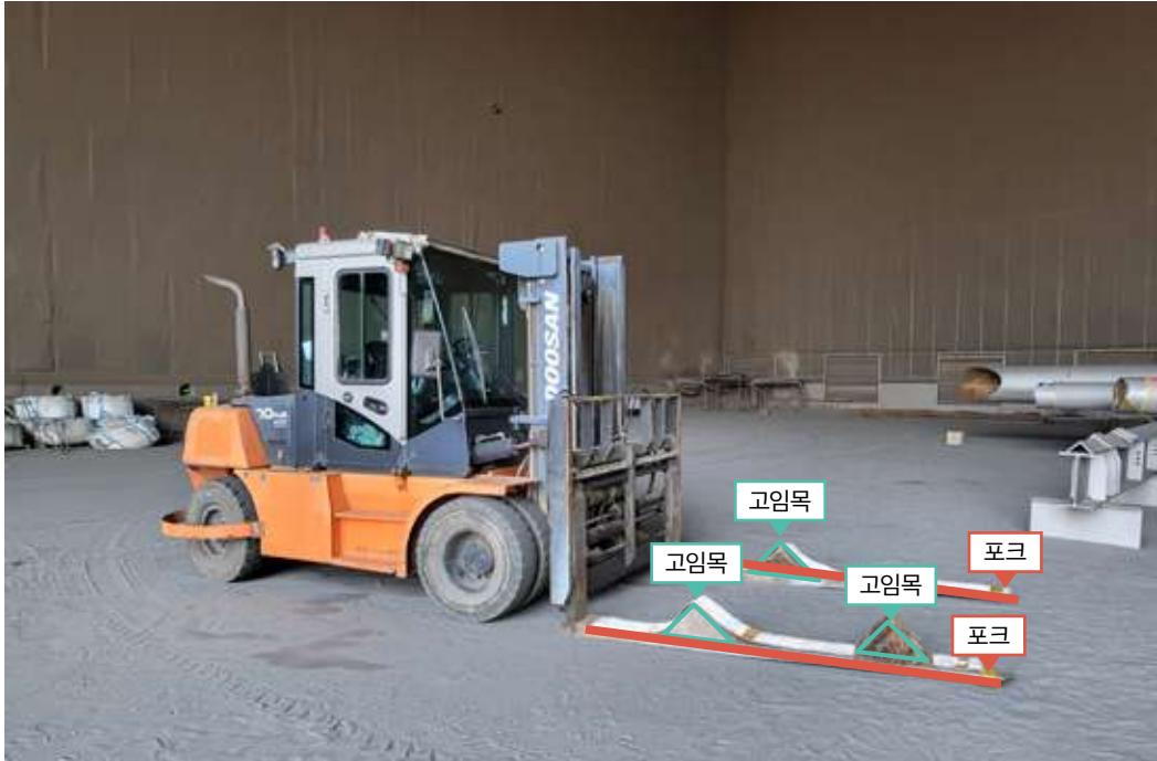
지게차에 표시된 부분이 포크이며, 포크 위 목재형 고임목이 보인다
