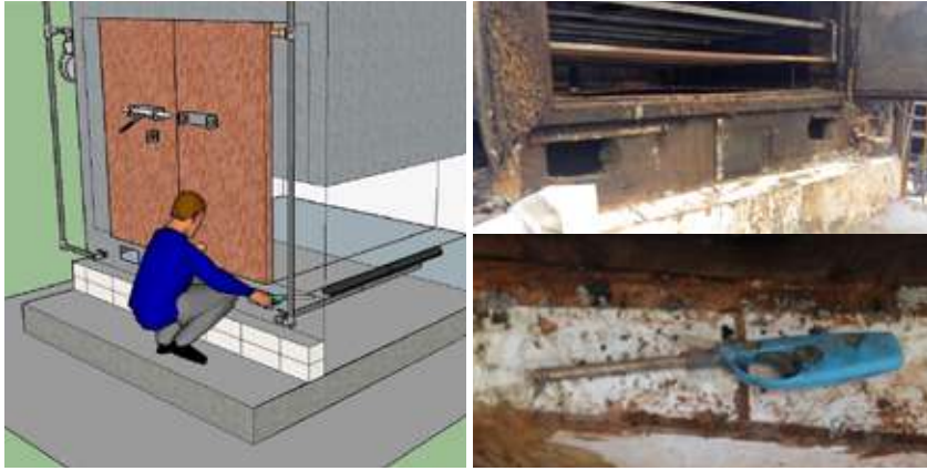
가마에 불을 붙이던 중 발생한 폭발 사고 개요도. 통풍구를 이용하여 휴대용 점화기로 불을 붙이던 중 사고가 발생했다
