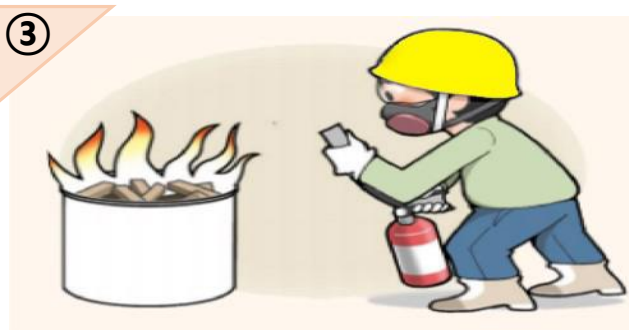
หันท่อดับเพลิงไปทางไฟ
