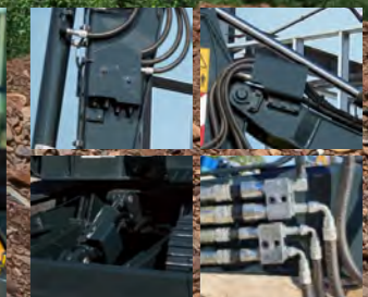
보호 커버 장착으로 장비 내구성 증대 NEW Upgrade 강화형 커버와 내부 보강판을 추가하여 유압라인과 도저 및 엔진후드의 내구성을 향상시켰습니다.
