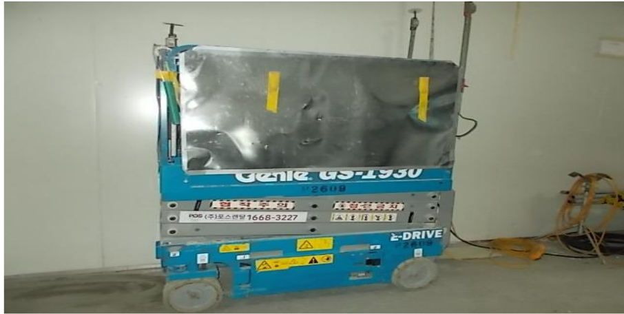
고소작업대 안전장치(풋스위치) 임의 고정
