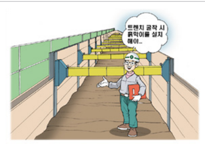
조립식 간이 흙막이 설치 또는 적정구배 준수
