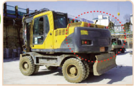
1 후진 경보장치 작동 (후진 기어 작동 시 자동 작동)
