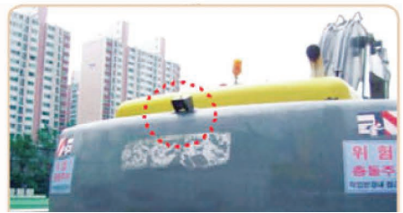
4 후방 감시카메라 설치
