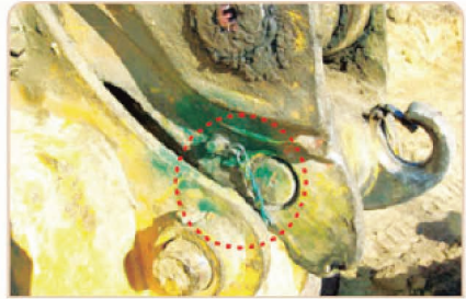
2 버킷 유압 커플러 안전핀 이탈 방지 장치 규격품 장착
