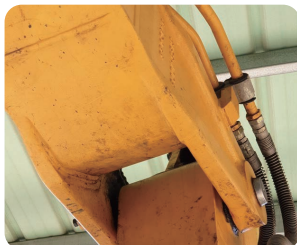
2 용접 후 다시 균열
