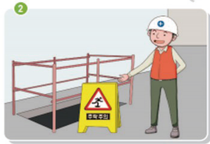
작업발판 및 통로 끝, 개구부 등 추락위험장소에 안전난간 등 설치
