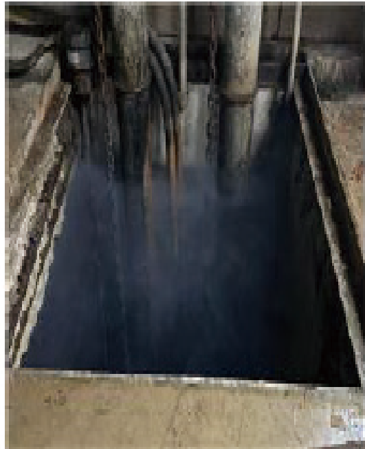
[사진2] 맨홀입구 기류상태 테스트 모습
