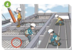
철골작업 시 근로자 주요 이동통로에 추락방호망, 안전대 부착설비 설치
