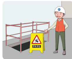
» 안전난간 및 경고표지 설치
