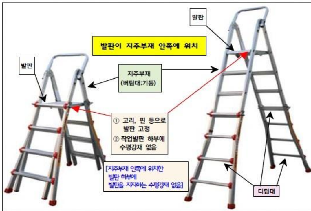
[발판이 지주부재 안쪽에 설치된 사다리 (하부에 수평강재없음) ; 작업발판으로 사용 불가]
